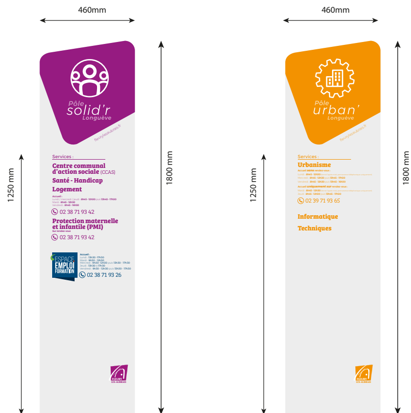
Totem d'entrée H 1800 x L 460mm x P 20mm Plexiglass, pose adhésif à verso (en inversé) Verso réservé pour la pose des textes en brailles type dymo®.
